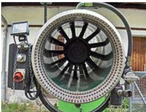
Vues de l'intérieur d'un canon à neige dernière génération Source : Wikipédia
